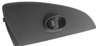
90.258 - Teclas acionadoras dos vidros elétricos c/ moldura - simples Palio - Weekend - Siena - Strada GI após 96 acabamento Stile N° Orig. 735.302.408
