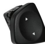
Tecla acionadora do vidro 90.616 - dir. 90.617 - esq. Uno GI após abril/10 - Fiorino GI após nov/13 N° Orig. 100.179.221 - 100.179.220
