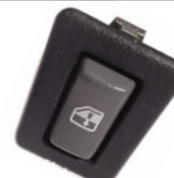
90.945 - Tecla acionadora do vidro - simples S-10 GI 95 à 12 - Blazer 96 à 11 - Silverado 97 à 02 - Suzuki Jimny 98 à 05 N° Orig. 15.999.364
